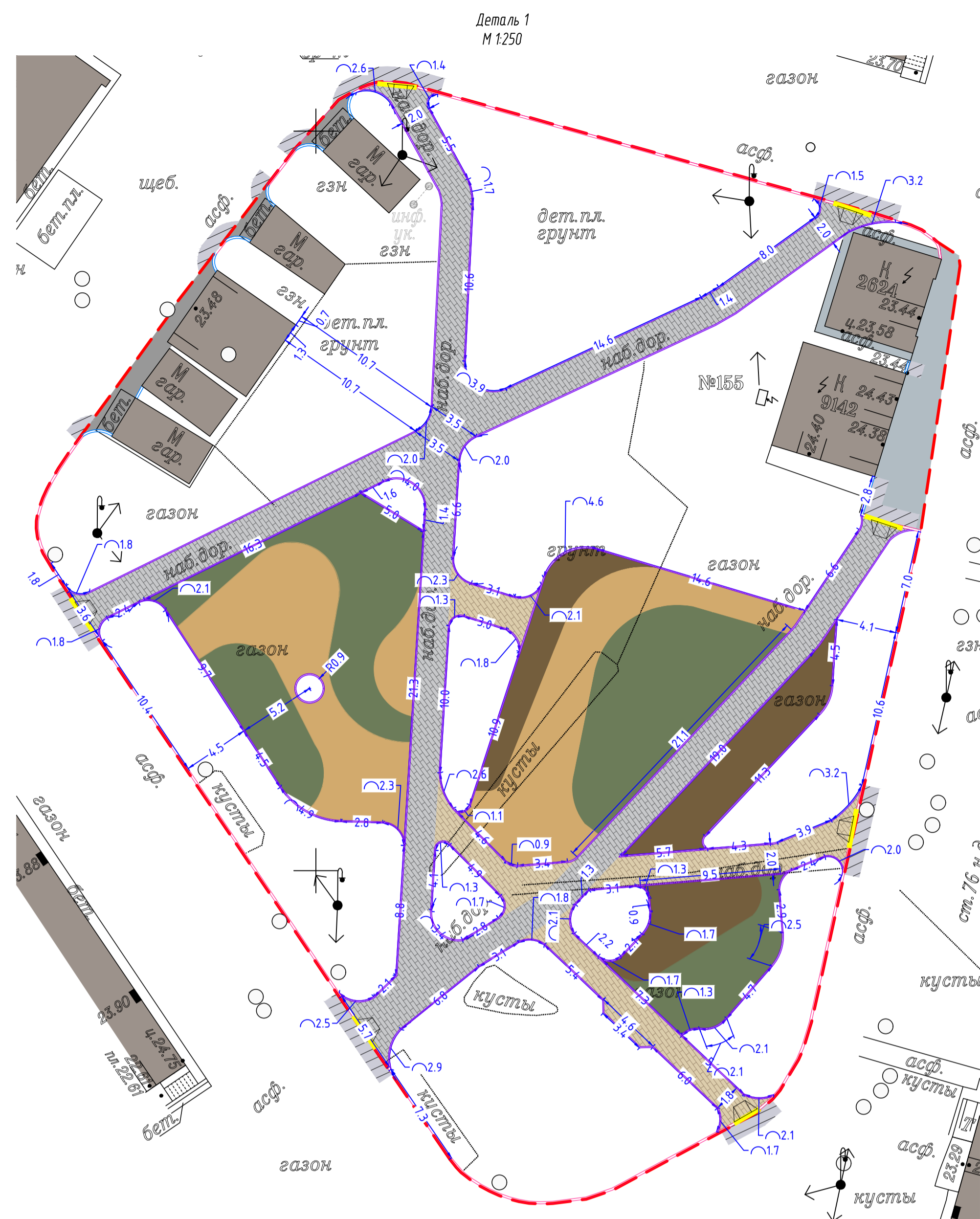
Схема устройства занижения бортового камня для передвижения маломобильных групп населения
